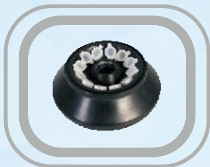
Angle Rotor AR-1: 12x1.5/2.2 ml
