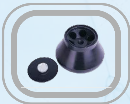
Angle Rotor AR-4: 6x30 ml
